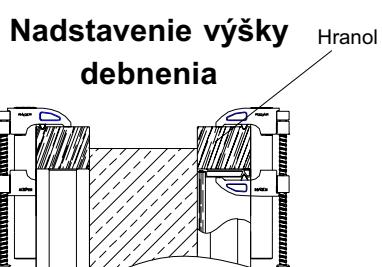
Pri vyšších nadstaveniach, sa za účelom stuženia panelovej zostavy musí použiť zrovňávacia koľajnica 150. Zrovňávacia koľajnica 100 sa používa hlavne pri vyrovnávacích vložkách a pri nadväzovaní debniacich taktov.
